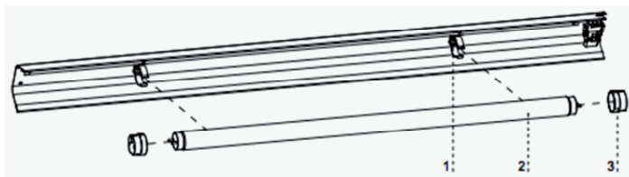
Rys.7 Wymiana świetłówki w lampie
